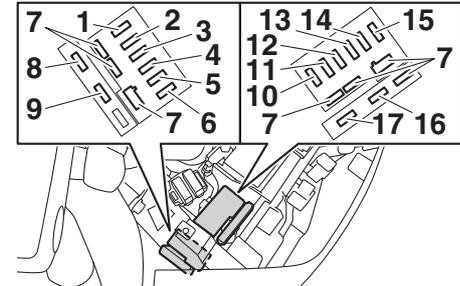
1. Sicherung des ABS-Motors
