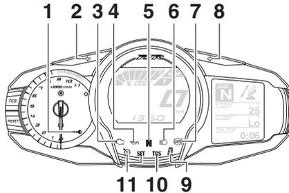
1. Anzeigelampe des Wegfahrsperrensystems "→"
