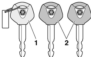
1. Schlüssel für die Re-Registrierung des Codes (rote Ummantelung)
