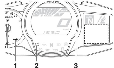
1. Anzeigeleuchte des Wegfahrsperrsystems "🚫"
