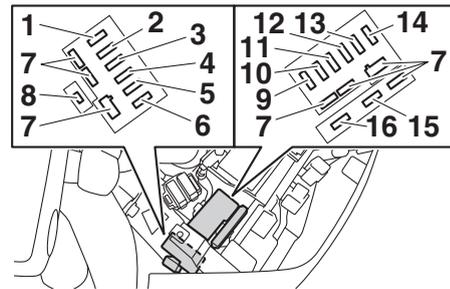
1. Sicherung des ABS-Motors
