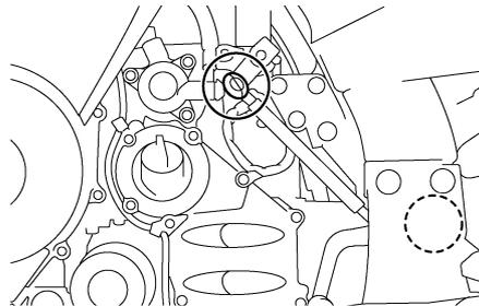
Vor Fahrtantritt die Funktion der Fußbrems- und Schalthebel prüfen und ggf. die Drehpunkte schmieren.
