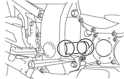
Die Schwingen-Drehpunkte müssen in den vorgeschriebenen Abständen geschmiert werden, gemäß der Tabelle für regelmäßige Wartung und Schmierung.
