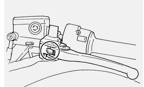
Vor Fahrtantritt die Funktion der Handbrems- und Kupplungshebel prüfen und ggf. die Drehpunkte schmieren.
