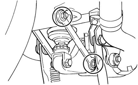
Die Drehpunkte der Hinterradaufhängung sollten in den empfohlenen Abständen gemäß Wartungs- und Schmier-tabelle geschmiert werden.
