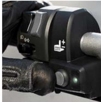
Schritt 4: Wenn das Gas geöffnet ist und die Drehzahl erhöht ist, erlaubt das System nicht, aus dem Leerlauf herauszuschalten.
